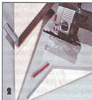
2 Передний и тыльный фронтоны домика выпиливают электролобзиком из фанеры толщиной 9 мм.
