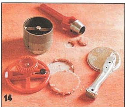
14 Ковролинные круги используют для ремонта покрытия или для создания на нём узоров. Круги вырезают пробойником или кругорезом. Впрочем, их можно вырезать и с помощью обычной крышки от жестяной банки.
