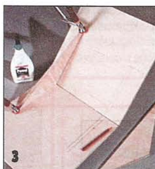
3 Крышу делают тоже из фанеры. Фронтоны и скаты крыши (угол наклона скатов — 25^{\circ} ) склеивают друг с другом.
