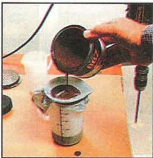
Для использования в краскопульте краску предварительно процеживают, чтобы не забились форсунки.
