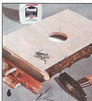
6 Распиленные ветки прибивают к кромкам плиты основания в виде ограды, препятствующей выпадению корма.
