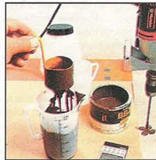
Вязкость краски перед заправкой краскопульты определяют с помощью вискозиметра.
