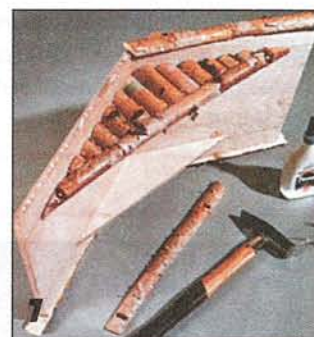
7 «Ветровые доски» и детали обшивки фронтона выкраивают также из распиленных вдоль берёзовых веток.
