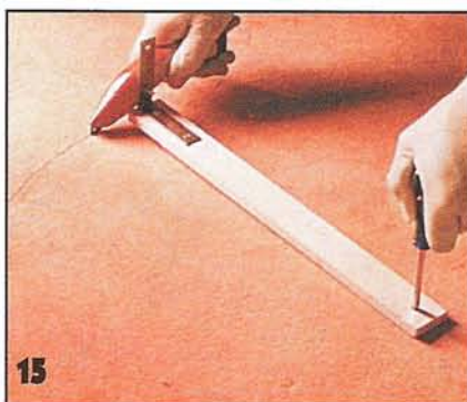
15 Большие круги вырезают самодельным циркулем-кругорезом, который делают из деревянной планки, уголка с привинченным к нему ножом и гвоздя в качестве иглы циркуля.
