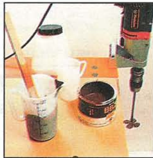
Размешивать лак лучше всего насадкой-пропеллером.
