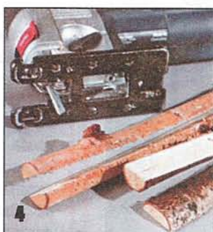
4 Высушенные берёзовые ветки диаметром \sim 3 см распиливают электролобзиком (или ножовкой) вдоль пополам.
